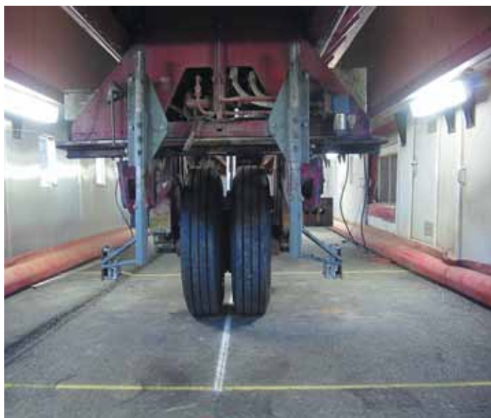
Tensar har gjennomført laboratorieundersøkelser over flere år, samt en rekke fullskala tester, for å evaluere stabiliseringseffekten av Tensar sine geonett anvendt i overbygninger.
