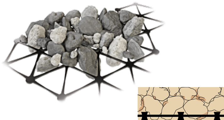
Steinmassene forkiles og låses mot hverandre i maskene i nettet, og følgelig forbedres komprimeringen over bløt grunn, og stivheten til det stabiliserte laget økes.
