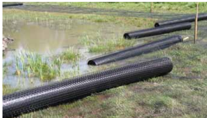
TriAx® gir steinmaterialene bedre fordeling og låsing, som vil øke den strukturelle funksjonen til det mekanisk stabiliserte laget.
